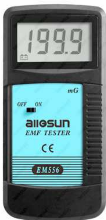
Модель EM556 фирмы All-Sun (1.3230руб). All-sun EM556 High Sensitivity EMF Tester 0.1-199.9mG 30HZ-400HZ Test the Magnitude of Electromagnetic Field Radiation. -Диапазон измерения: 0.1 ~ 199.9 мГ (МГС)(mG, milligauss) . -Точность: \pm (10% от чтения + 8 цифр), на 50 Гц/60 Гц -Частотный диапазон: 30 Гц ~ 400 Гц
