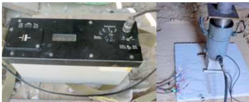
Прибор ЕИЭМПЗ «Одонис-3», произведенный АО «Фиолент» и размещение антенн при испытании фундамента.
